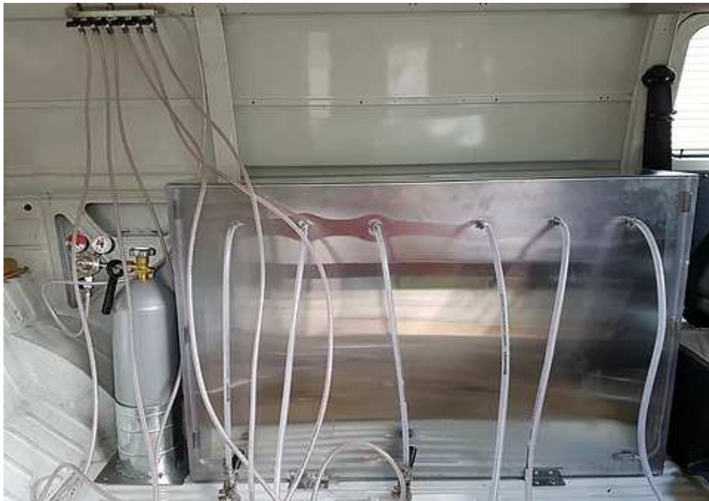
Figura 6 – Sistema completo instalado (caixa, mangueira atóxica e cilindro de oxigênio)
