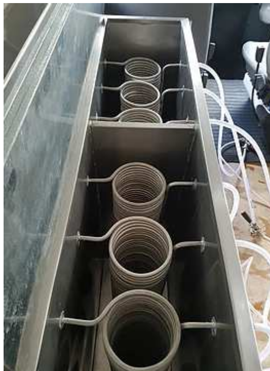
Figura 5 – Choperia a Gelo 6 vias com 60 metros de serpentina.
